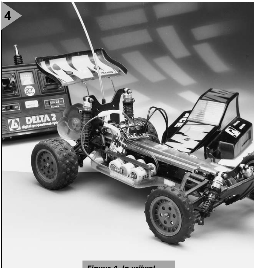
Figuur 4. In vrijwel ieder modelvoertuig, of het nu een auto, boot of vliegtuig is, kan de schakeling gebruikt worden om een mechanische regelaar te vervangen door een elektronische versie.
